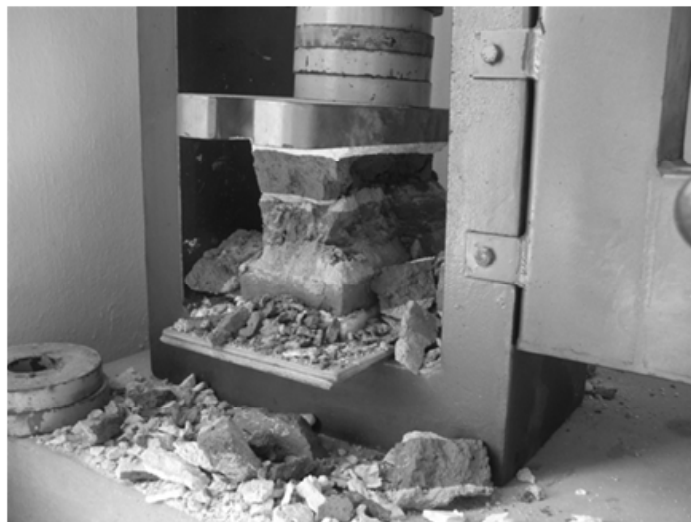
Figura 6 Ensayo a compresión de una pila de ladrillos. Se obtuvo el área de la sección transversal de la cara superior de cada pila y se procedió al ensayo de resistencia a compresión. En la Tabla 4 se presentan las resistencias a compresión representativas de cada lote ensayado.
