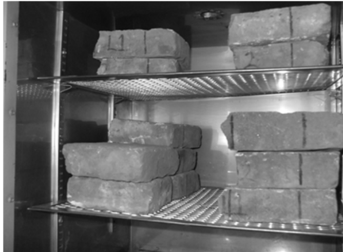
Figura 3. Proceso de secado en horno
