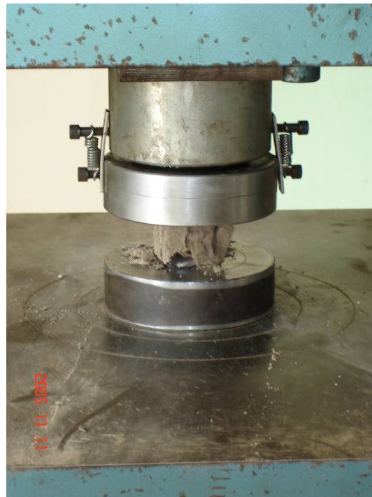
Figura 8. Ensayo a compresión de una probeta de mortero
